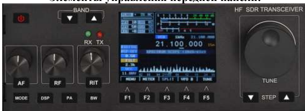
Рисунок 1: Элементы управления передней панели приемопередатчика mcHF
